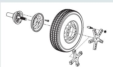
► **SR 215/2:** due flange a 4 e 5 bracci con colonnette per ruote di veicoli pesanti (in alternativa al kit IV/V/GG) Ø 10 x 225 / 285,75 / 335; 8 x 275 / 285,75 mm.
