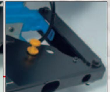
**BRACCIO STALLONATORE CON SISTEMA COMBINATO:** la nuovissima combinazione dei movimenti tradizionale ed a parallelogramma (selezionabili attraverso un semplice movimento del perno di tenuta) consente la stallonatura ottimale per ogni tipo di pneumatico. Regolabili anche l'angolo d'inclinazione ed il ritorno della palette.
