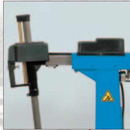
**SISTEMA DI BLOCCAGGIO PNEUMATICO A TRIPLA AZIONE:** garantisce un bloccaggio combinato in verticale, orizzontale e diagonale del braccio operante e del palo orizzontale, che elimina tutti i possibili giochi meccanici.
